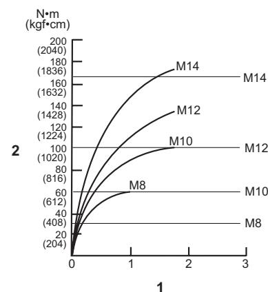
1. Tilspændingstid (sekunder) 2. Tilspændingsmoment
