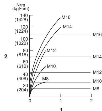
1. Tilspændingstid (sekunder) 2. Tilspændingsmoment
